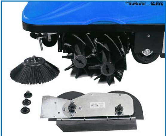
Walzen- und Seitenbesen lassen sich schnell und werkzeuglos wechseln
